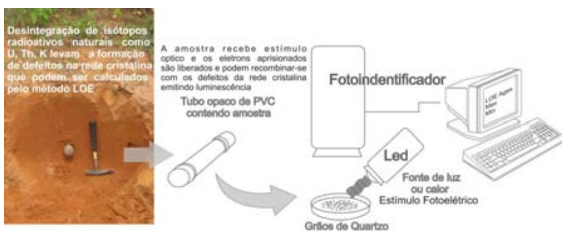
Figura 7.2 Esquema simplificado da Datação por Luminescência.
