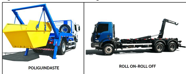
Figura 12 – Caminhões Poli-guindaste e Roll On-Roll Off
