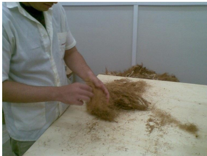
Figura 29 - Cardagem manual da fibra de coco seco
