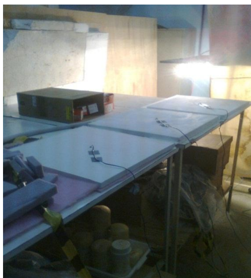
Figura 50 - Termopares fixados nas placas
