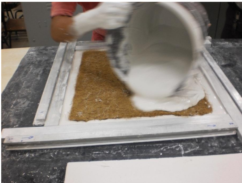
Figura 40 - Colocação da 2ª camada de gesso
