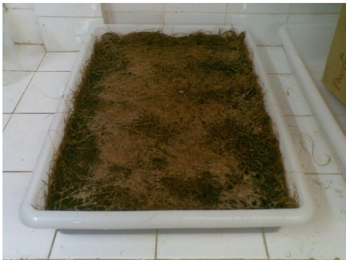
Figura 30 - Fibra de molho em solução de hidróxido de sódio
