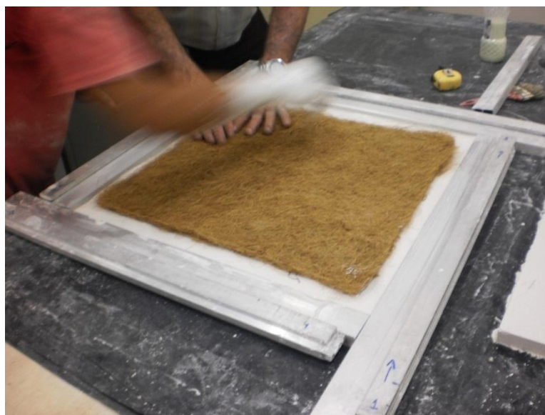
Figura 39 - Colocação da manta
