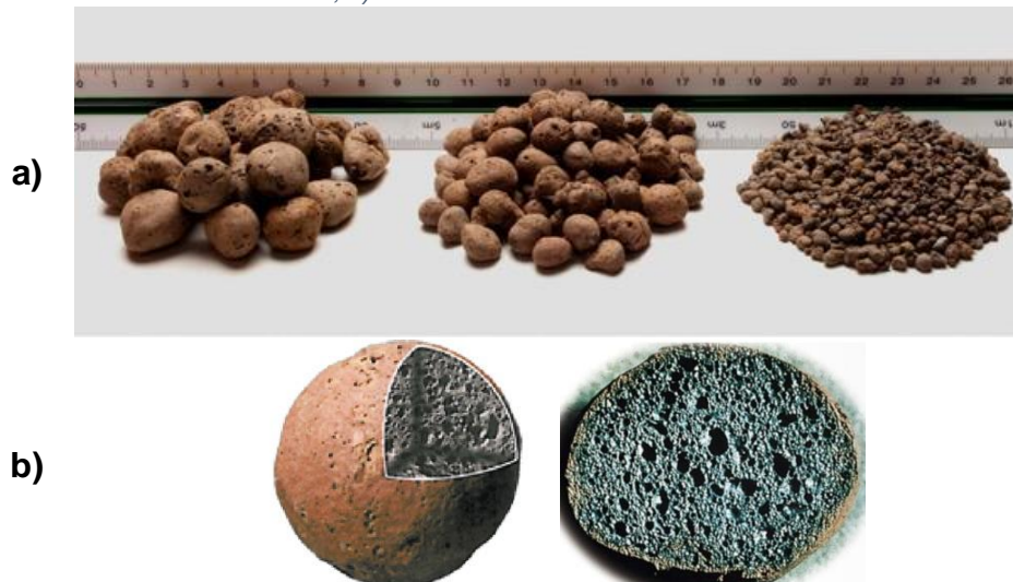
Figura 6 – a) Diferentes tamanhos de LECA; b) Furos interconectados e cavidades cheias de ar de diferentes tamanhos
