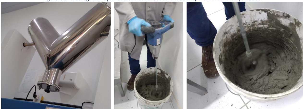
Figura 33 - homogeneização dos materiais secos e mistura para alimentar impressora
