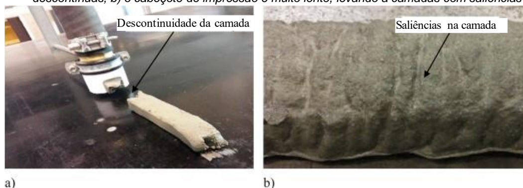
Figura 22 - Resultados da impressão 3D assíncrona: a) o cabeçote de impressão é muito rápido, levando a camadas descontínuas; b) o cabeçote de impressão é muito lento, levando a camadas com saliências
