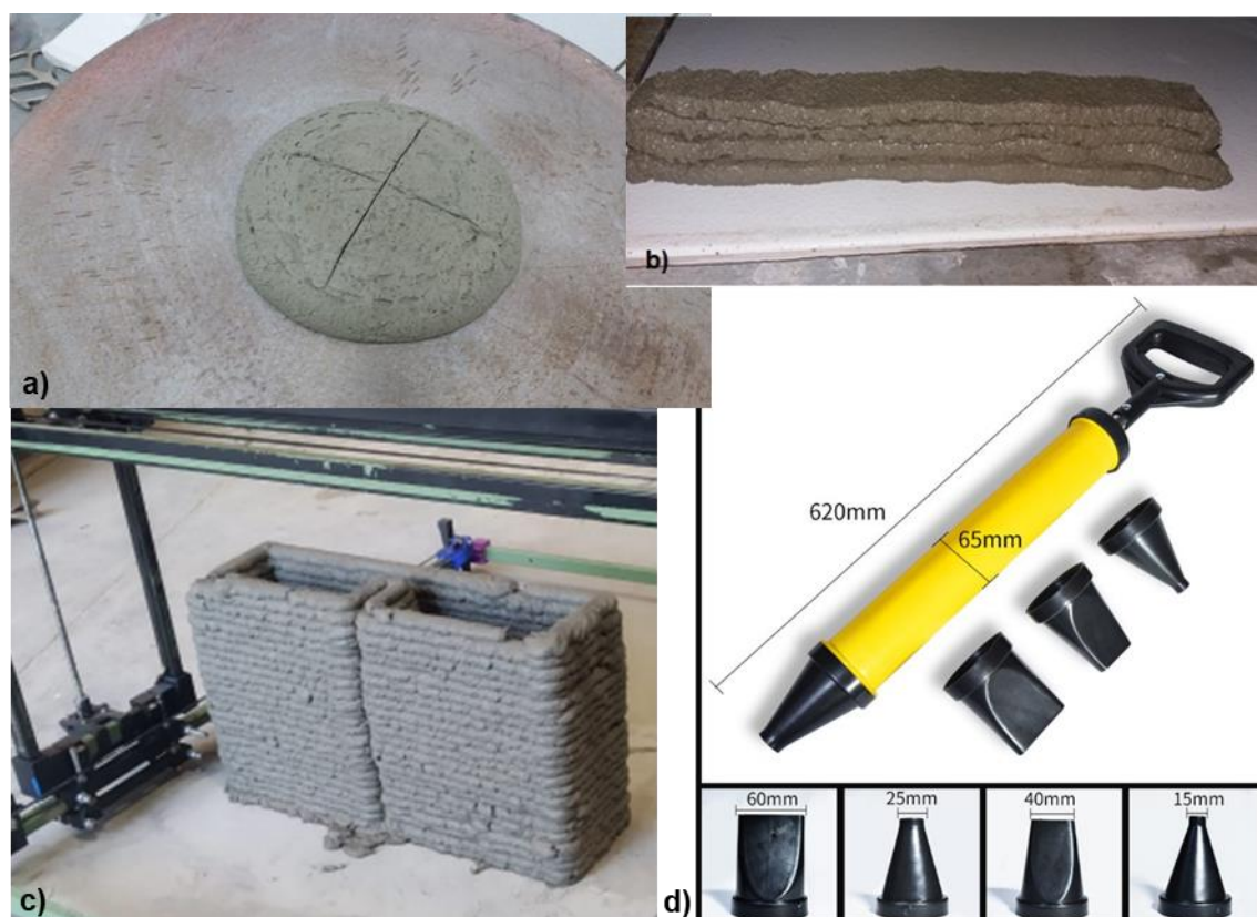
Figura 31 - a)Espalhamento, b) extrusão com pistola, c)impressão da mistura R100 e d) detalhe da pistola usada na extrusão
