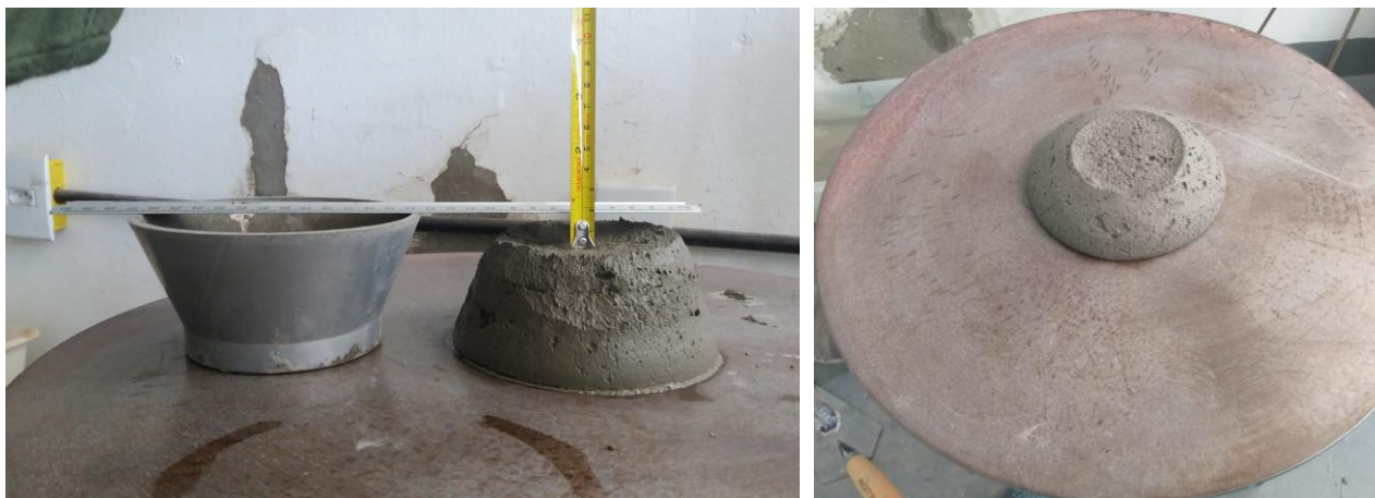
Figura 34 - Configuração experimental do teste de vazão (a) antes da remoção do molde (b) a dispersão do material após deixar a mesa cair 25 vezes.
