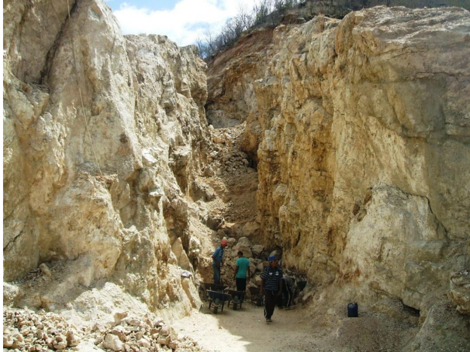
Figura 4: Extração artesanal a céu aberto em rocha pegmatítica no sítio Cumbe, Parelhas/RN
