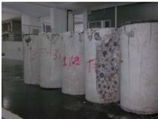
Figura 4.2 - Descrição da ruptura colunar à compressão axial
