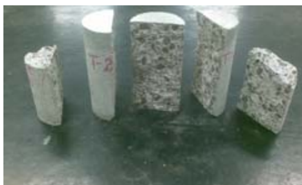
Figura 4.3 – Descrição da ruptura à tração por compressão diametral
