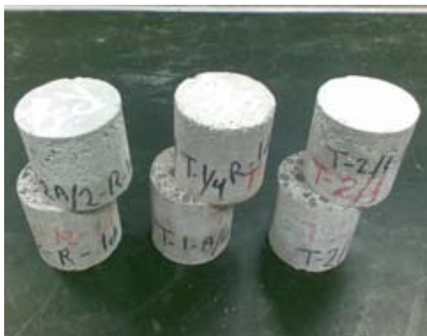
Figura 3.10 - Corpos de prova serrados ao meio
