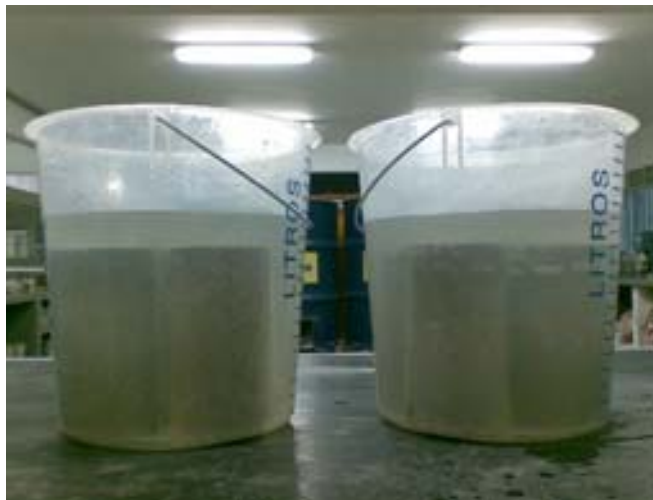
Figura 3.9 – Corpos de prova em solução de NaCl ( 12% em massa)
