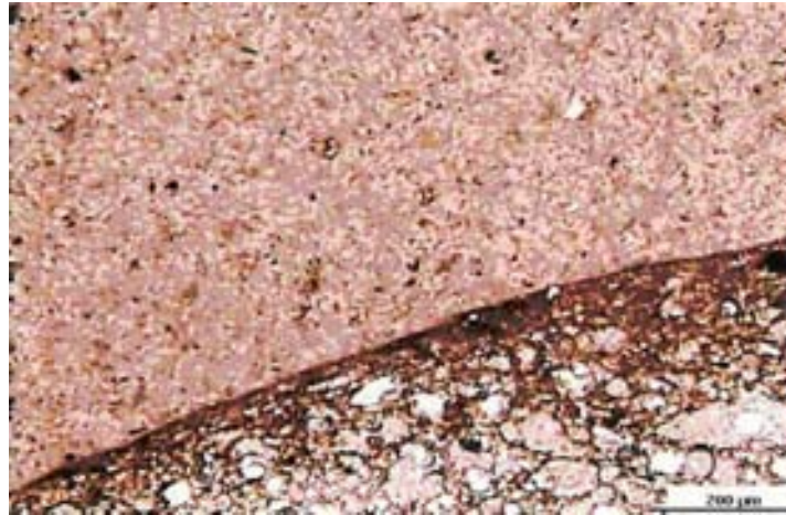
Figura 2.11 – Zona de transição entre o agregado leve e a matriz de cimento (Micrografia ótica de transmissão -100x) (ROSSIGNOLO, 2003)
