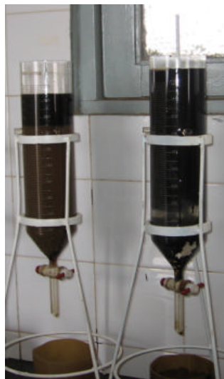
Figura 2 – Amostra nas provetas para análise de BS&W total
