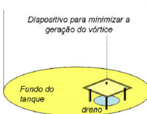
Figura 4 – Proteção do dreno de fundo
