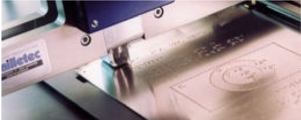
Figura 13: Impressão de matriz para cópias em relevo por meio de imprensa Braille.
