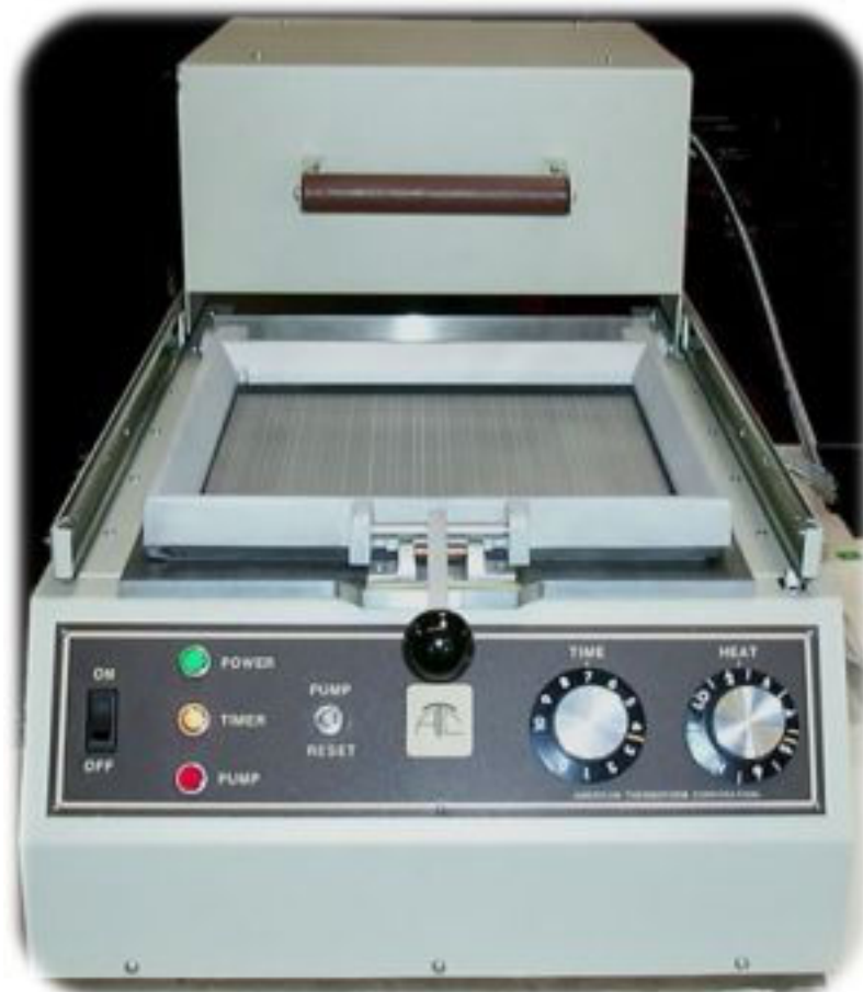
Figura 9: THERMOFORM - Equipamento utilizado para cópia de matrizes em relevo por meio de calor e vácuo.
