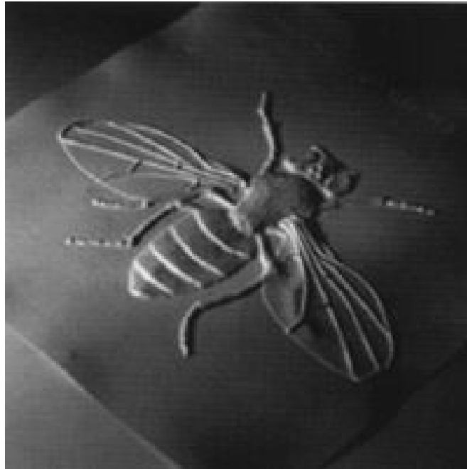
Figura 7: Imagem representativa de uma abelha reproduzida por meio do THERMOFORM.
