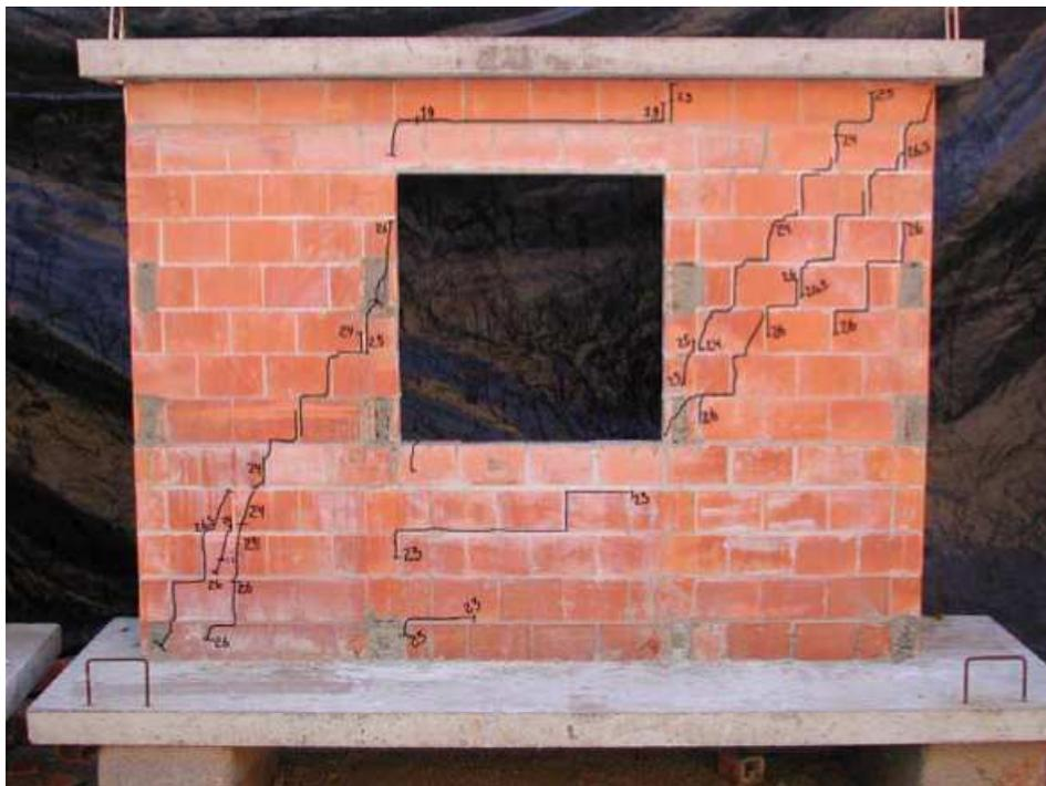
Figura 4.17 – Vista geral do modelo após a realização do ensaio do painel com abertura de janela.
