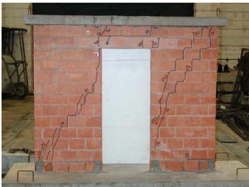
Figura 4.12 – Fissuração das paredes do modelo PPCG1. Fonte: Nascimento Neto (2003).
