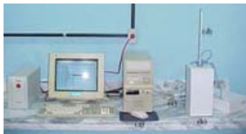
Figura 4.2 – Bancada de calibração - UFRN/NTI/LTC: (a) SAD; (b) Calorímetro; (c) Terminal de compensação de junta fria; (d) TLBV.
