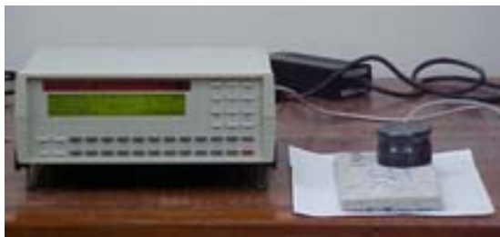
Figura 4.11 – Determinação da condutividade térmica e do calor específico dos blocos de concreto.
