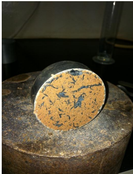
Figura 4.10 – Corpo de prova da mistura solo – resíduo de pneus no anel de adensamento.
