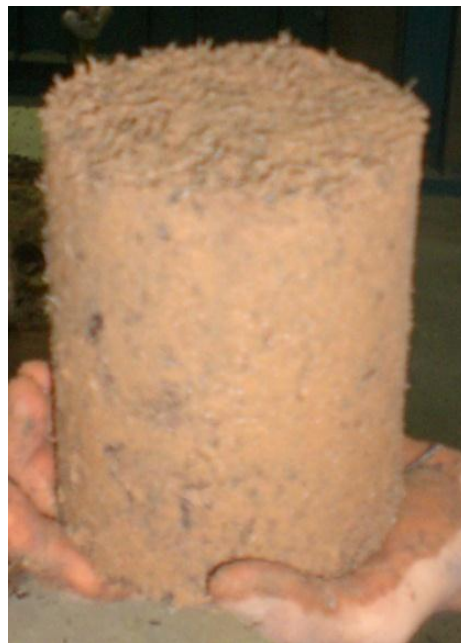
Figura 4.7 – Corpo de prova moldada com \chi = 10\% de resíduo de pneus.
