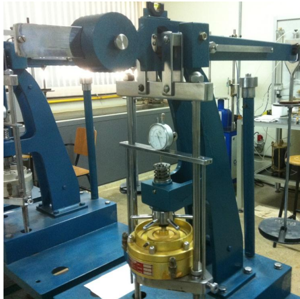
Figura 4.11 – Montagem de ensaio de compressão confinada
