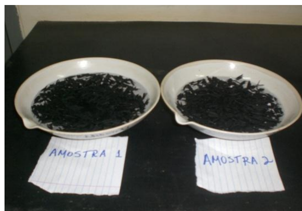
Figura 4.6 – Amostras de desbastes de pneus imersos em água destilada para ensaio de absorção.
