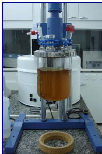
Figura 4.1 - Reação do metóxido de potássio com o óleo de algodão, no reator EROSTAR
