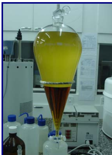
Figura 4.2 - Separação da glicerina e do biodiesel de algodão da rota metílica
