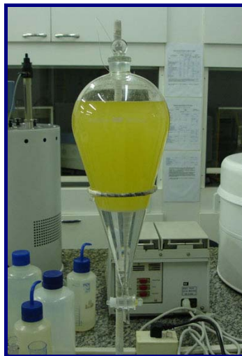
Figura 4.3 - Processo de lavagem do biodiesel metílico
