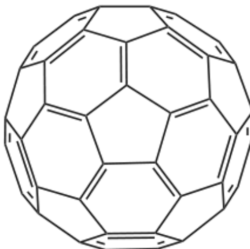
Figura 3 - Representação tridimensional do fulereno.
