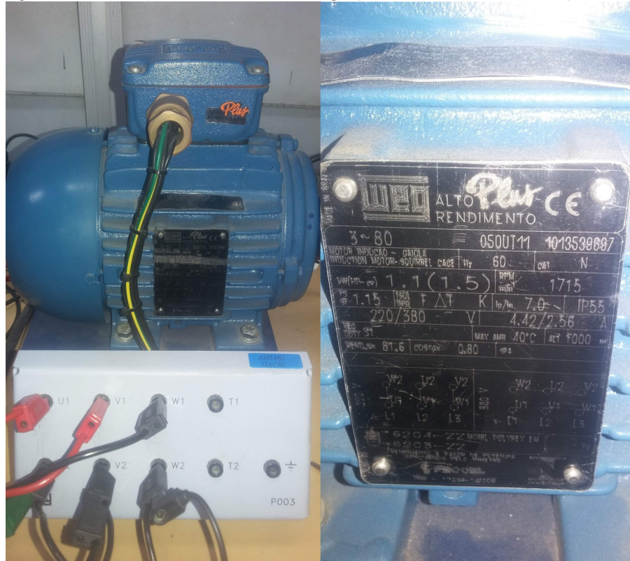
Figura 32: Motor utilizado como carga para avaliar o fator de potência.
