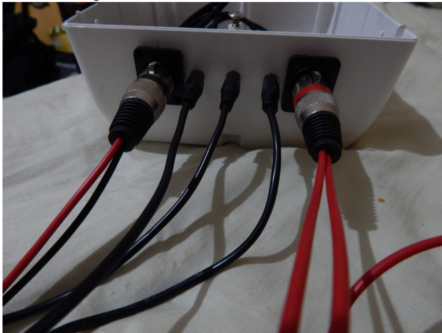
Figura 22: Conexão dos sensores ao medidor.
