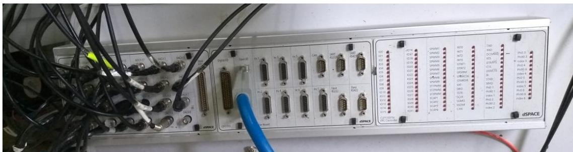
Figura 6.11: Foto do sistema de aquisição e processamento de dados dSPACE 1103.
