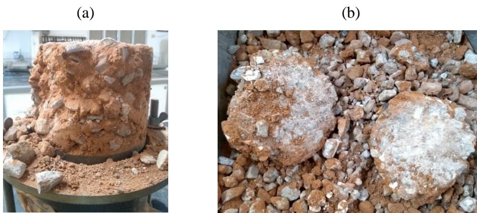
Figura 56 – Resultados do procedimento de compactação do Solo-RCD: a) corpo de prova extraído após primeiro ponto da compactação; b) corpo de prova aberto ao meio
