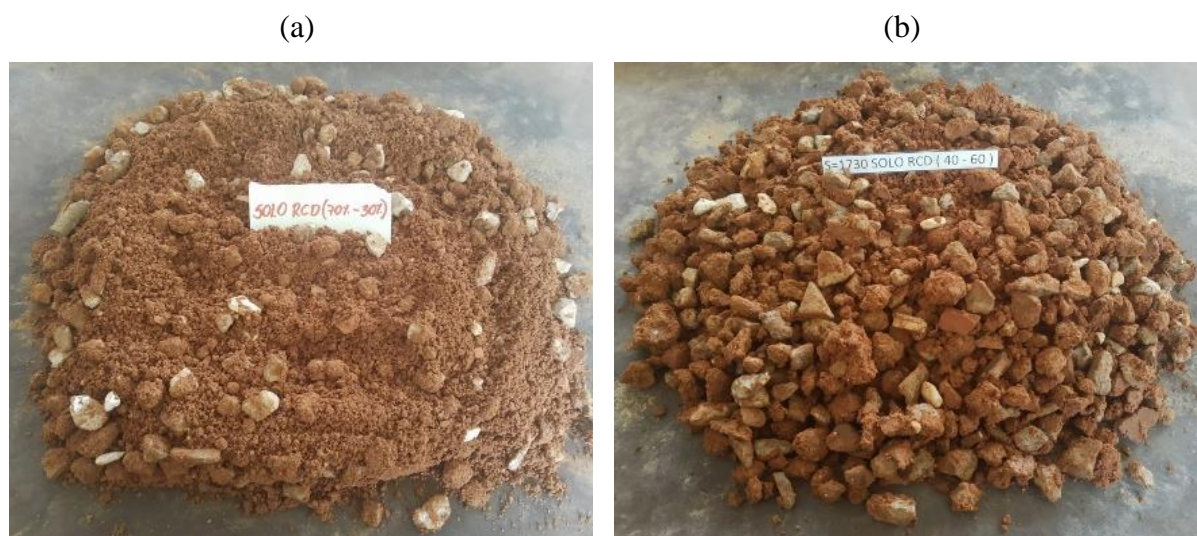
Figura 28- Misturas de Solo-RCD após procedimento de homogeneização: a) Solo-RCD 70-30; b) Solo-RCD 40-60
