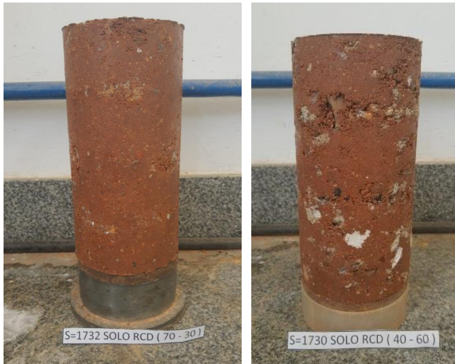
Figura 31 - Corpos de prova das misturas de Solo-RCD preparados para o ensaio de MR
