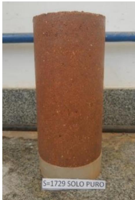
Figura 29 – Corpo de prova de solo puro preparado para o ensaio de MR
