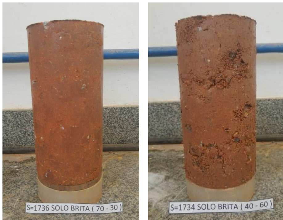
Figura 30 – Corpos de prova das misturas de Solo-Brita preparados para o ensaio de MR
