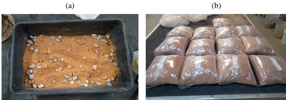
Figura 24 – a) Mistura de Solo-Brita 85-15 após homogeneização; b) misturas pesadas e embaladas para envio para a COPPE/UFRJ
