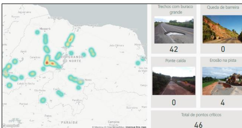
Figura 8 – Localização e Exemplos de Pontos Críticos dos pavimentos do Estado do Rio Grande do Norte
