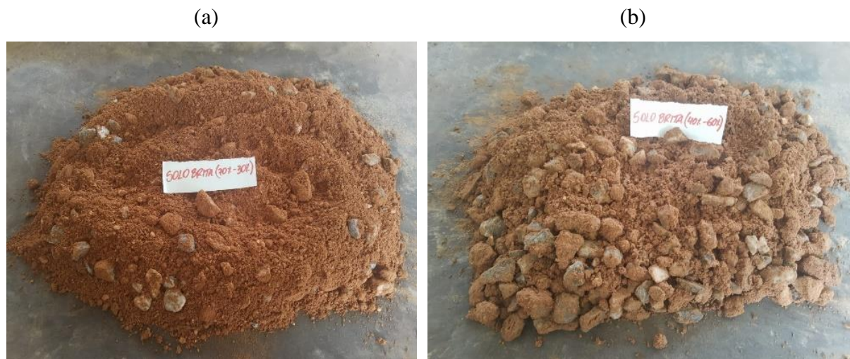
Figura 27 – Misturas de Solo-Brita após procedimento de homogeneização: a) Solo-Brita 70-30; b) Solo-Brita 40-60
