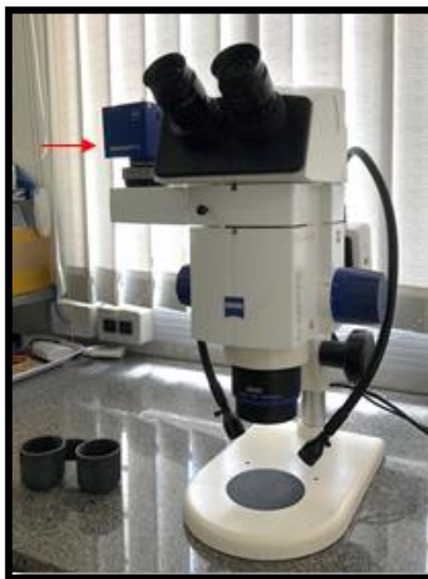
Figura 3.3 - Microscópio Discovery V8 da Carl Zeiss e câmera acoplada (seta vermelha)
