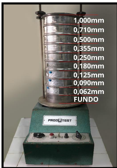
Figura 3.1 – Peneiras e respectivas malhas dispostas em ordem decrescente e acopladas ao agitador
