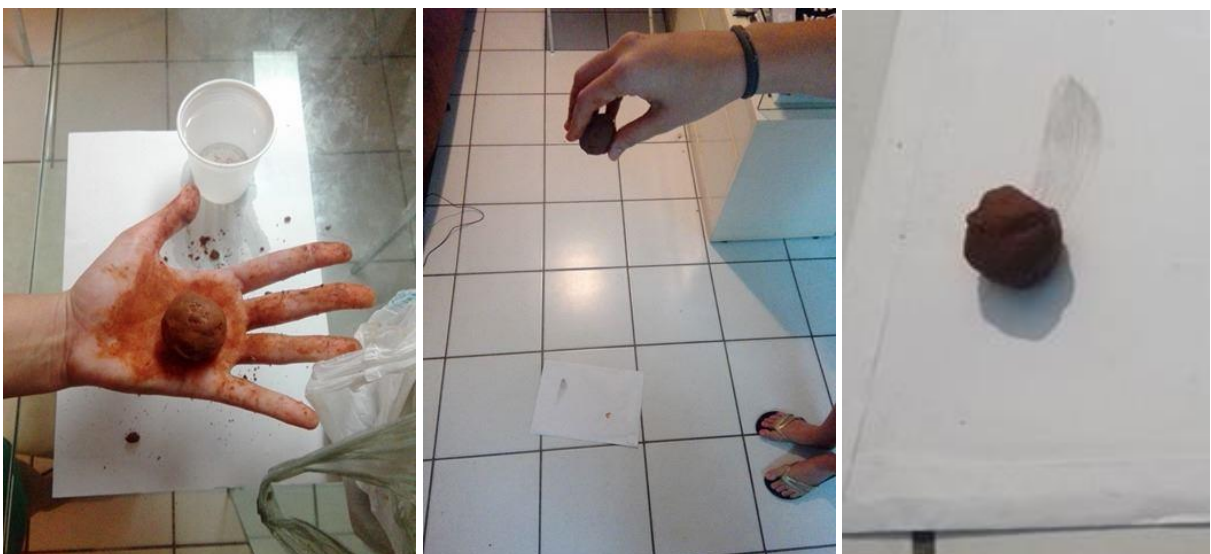
FIGURA 58: Teste da Bola Fonte: Acervo do autor, 2017.
