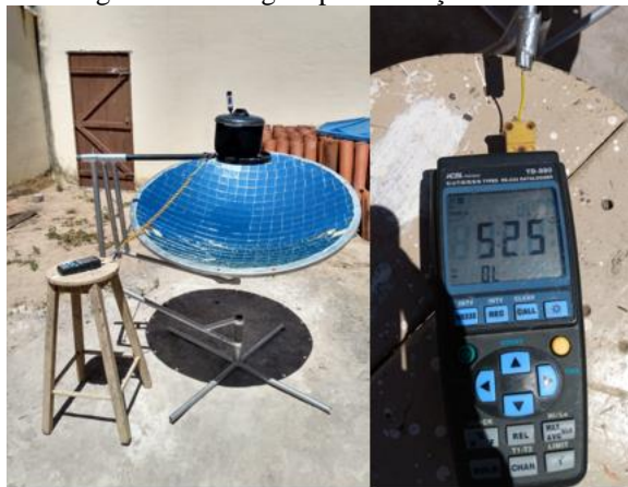
Figura 9: Montagem para medição de foco.
