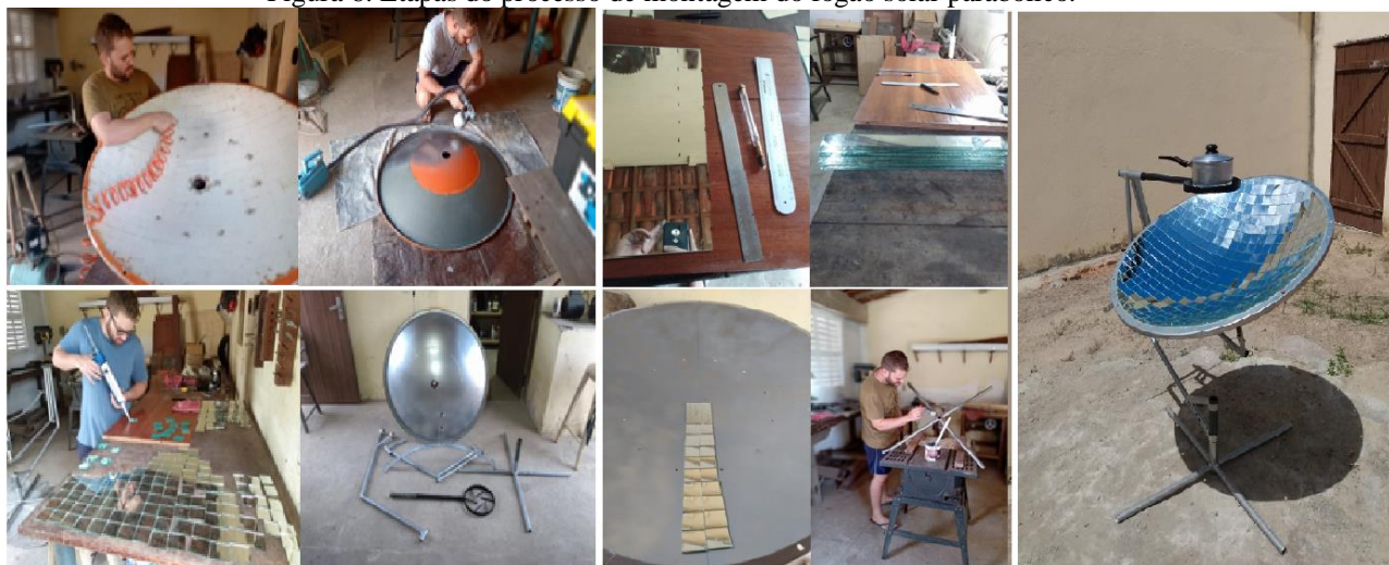
Figura 6: Etapas do processo de montagem do fogão solar parabólico.
