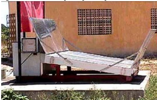
Figura 5: Coletor de placa plana aplicado a cozinha.
