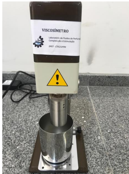
Figura 11. Viscosímetro Ofite, modelo 800.
