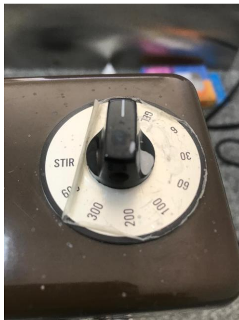
Figura 12. Chave seletora do Viscosímetro.
