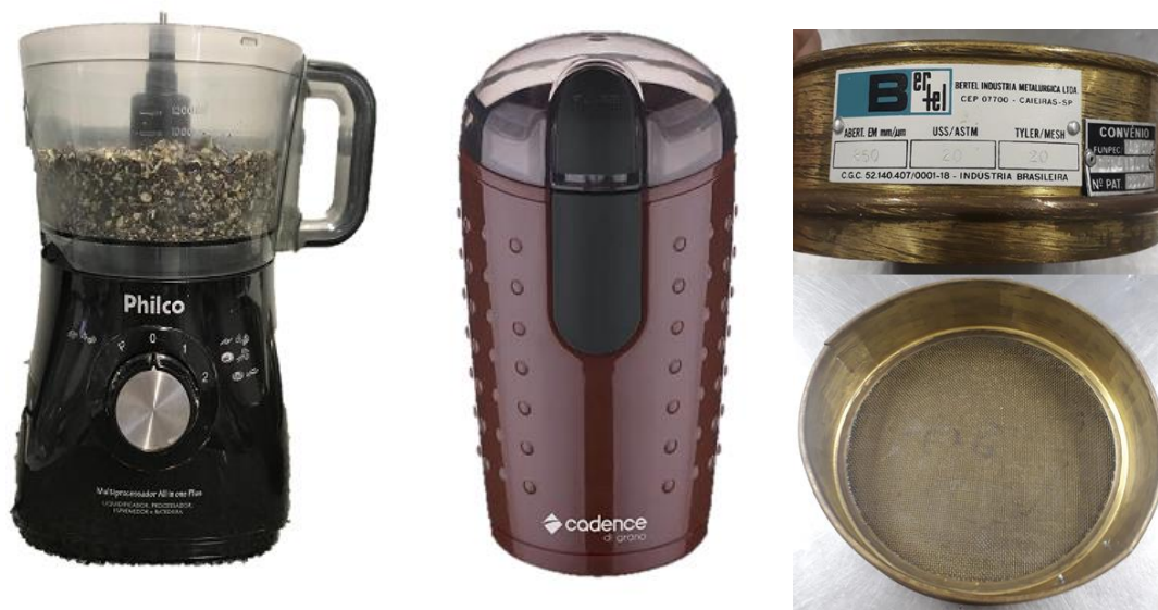
Figura 1: Equipamentos utilizados para triturar e peneirar o resíduo da prensagem da semente de faveleira.
