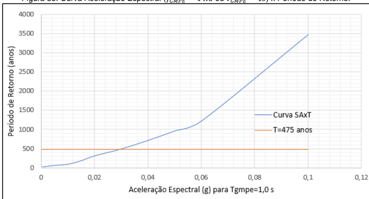
Figura 55: Curva Aceleração Espectral ( f_{GMPE} = 1 \text{ Hz} ou T_{GMPE} = 1 \text{ s} ) x Período de Retorno.
