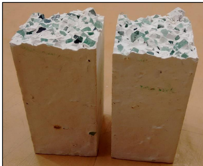
Figura 7: Corpo de prova rompido à flexão
