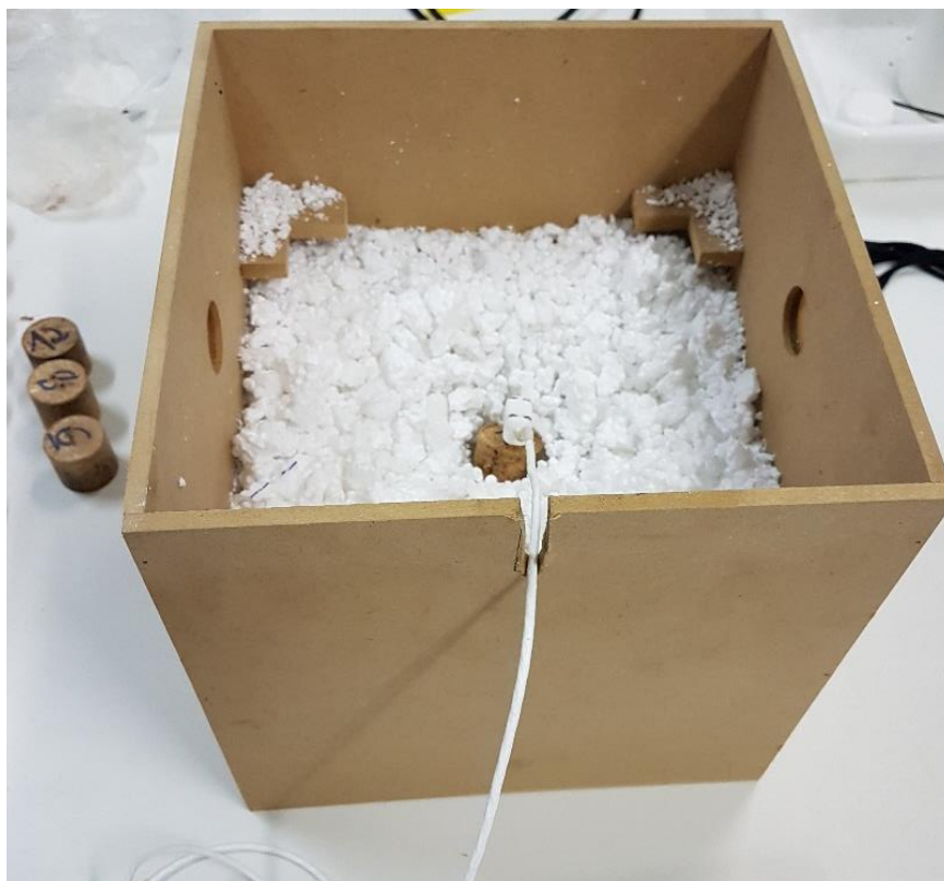
Figura 3.9. Câmara preenchida com material isolante.
