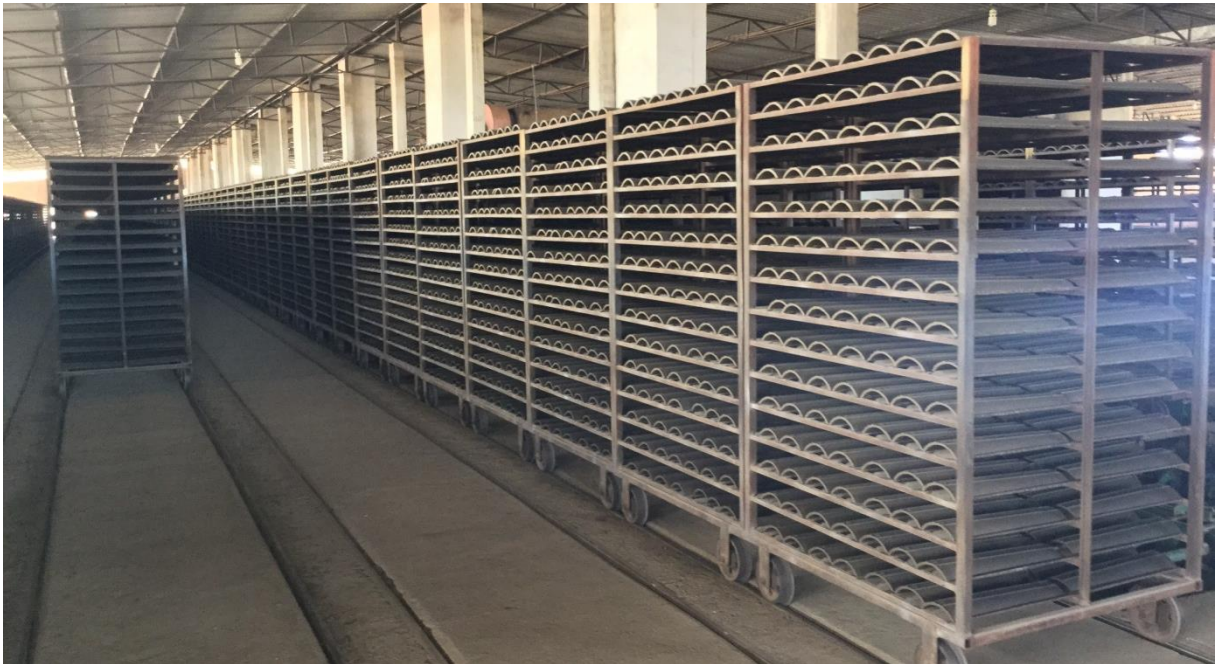
Imagem 05: Fotografia das telhas em vagonetas, antes de irem para o forno. Fonte: Elaborado pelo autor (2015)
