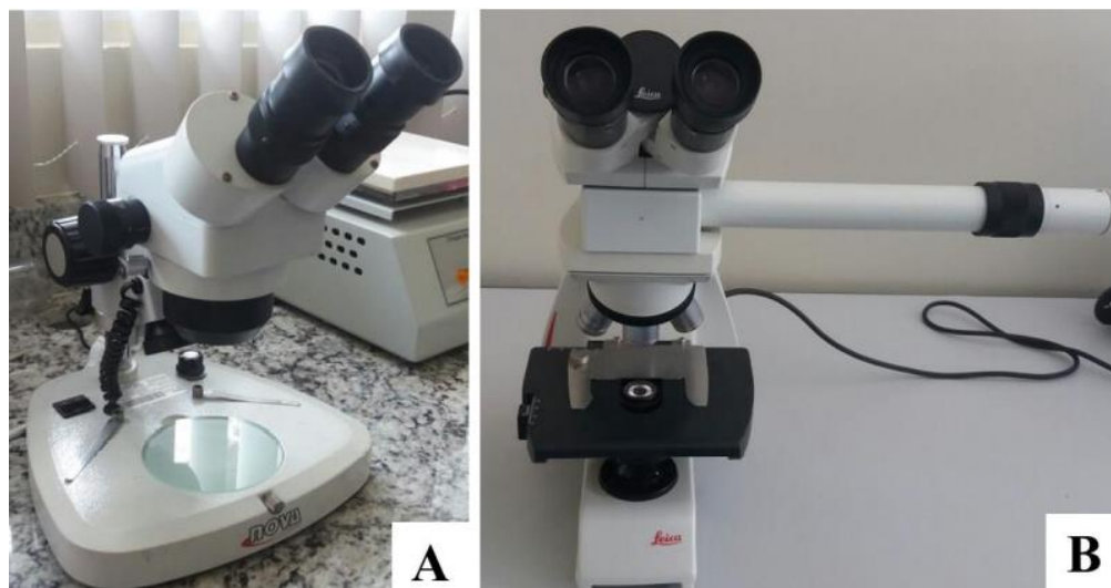
Figura 11 – A - Microscópio estereoscópico Nova ZTX-G; B - e microscópio óptico Leica DM500 com câmara clara (Souza, 2017).
