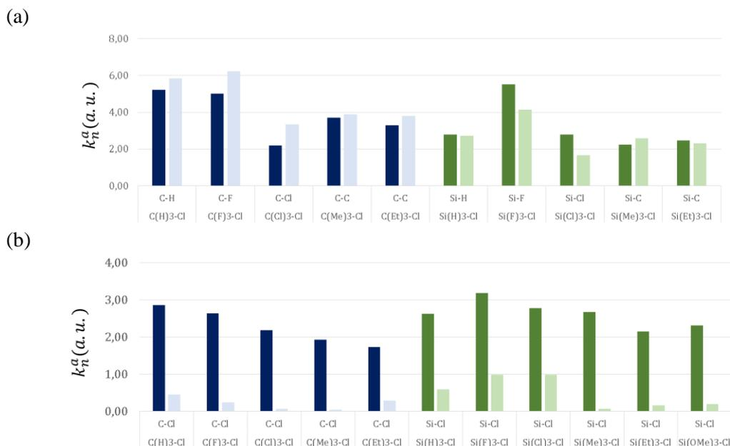
**Figura 13.** Constantes de força ( $k_n^a$ ) para as ligações: (a) A-R e (b) A-X nos sistemas reagentes (cores escuras) e estruturas transicionais (cores claras), para as reações  $S_N2@C$  (azul) e  $S_N2@Si$  (verde).
