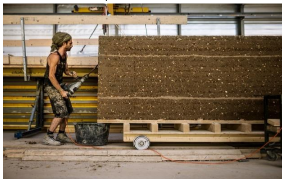
Figura 27: Produção de grandes blocos taipa em fábrica local.
