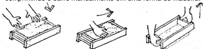
Figura 26: Esquema de Legen (2014) - Tijolos de adobe feitos de forma individual, comprimindo o barro manualmente em uma forma de madeira.
