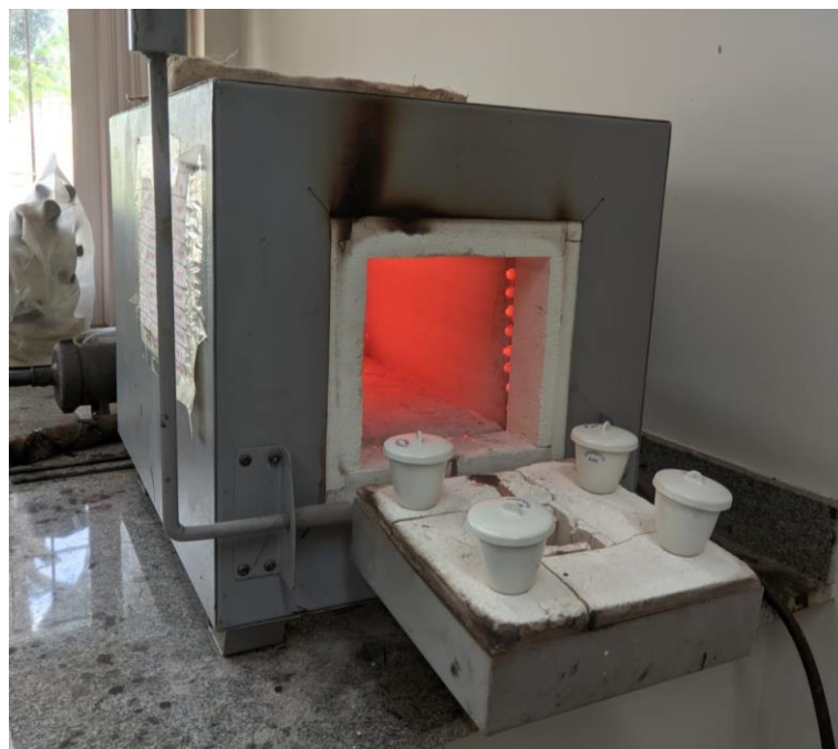
Figura 2: Análise química imediata do biochar . Mufla com os cadinhos posicionados para aclimação e realização da análise de materiais voláteis.
