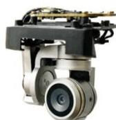
**Figura 5.** Câmera Hasselblad modelo L1D-20c, com sensor CMOS de 20MP
