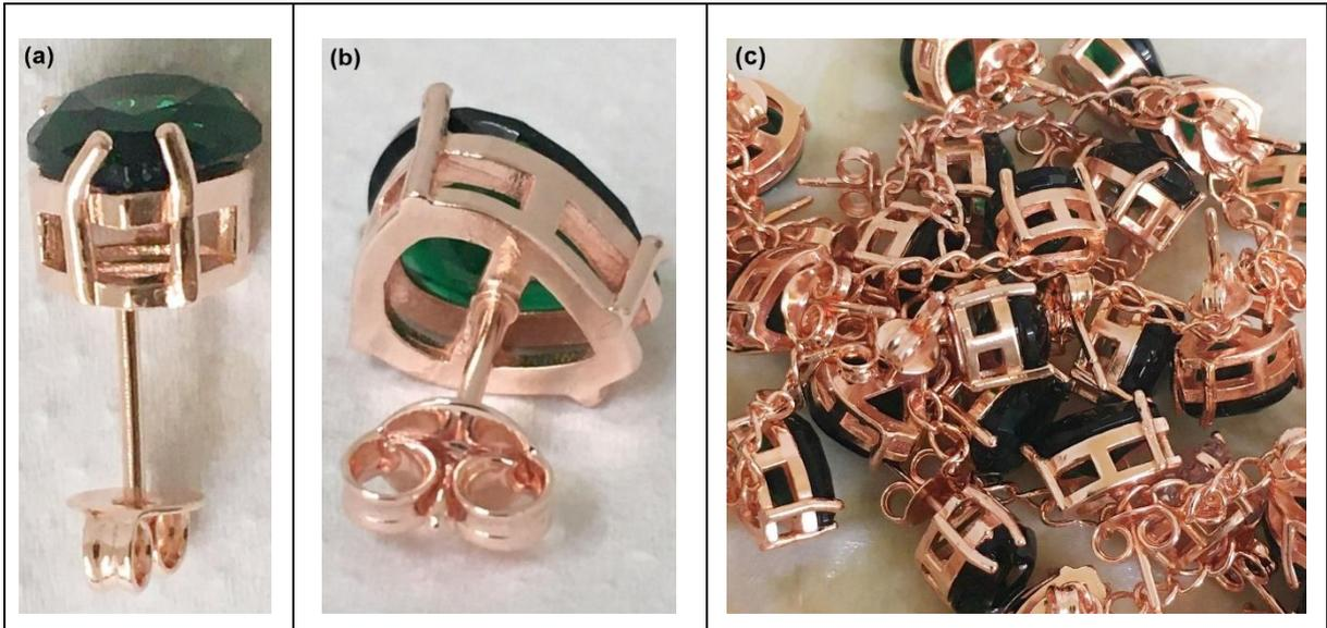
Figura 14. Acessório (a), (b) e (c) após o depósito de cobre ácido na superfície.
