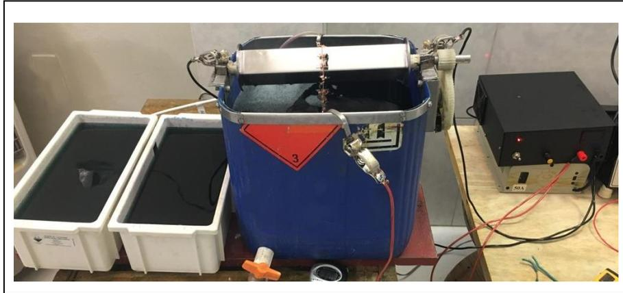
Figura 8. Equipamentos necessários e desenvolvidos para a eletrodeposição de cobre ácido.
