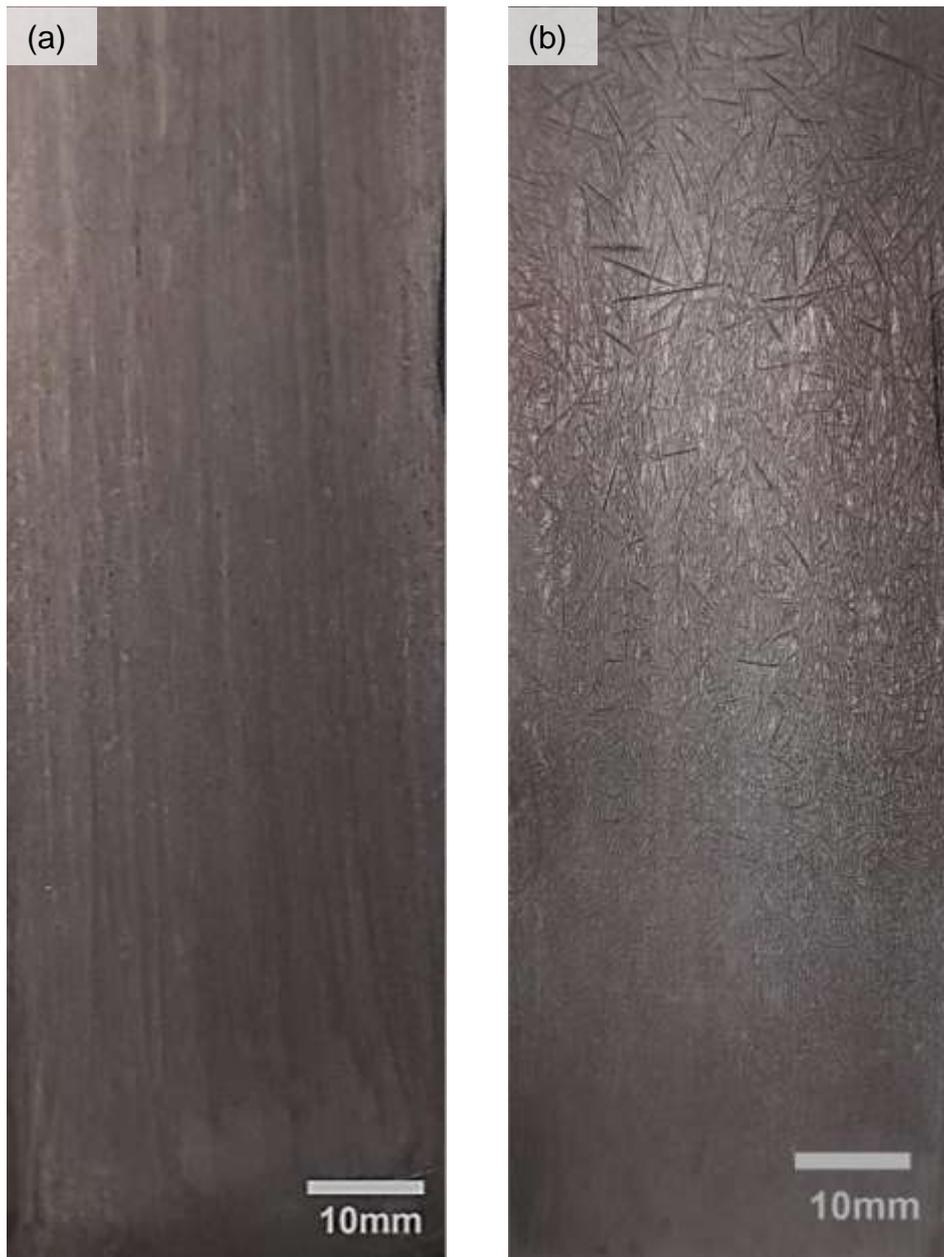
Figura 37. Macroestruturas dos lingotes (a) Sn-34%Bi -0,5%Zn; (b) Sn-34%Bi-9%Zn.
