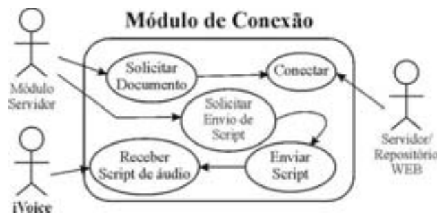
Figura 23 Casos de Uso - Módulo de Conexão
