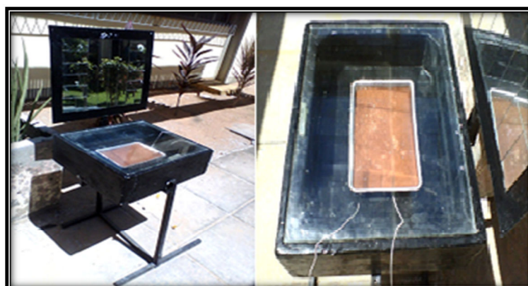
Figura 25 – Forno solar fabricado a partir de chapas de material compósito de baixa condutividade térmica.
