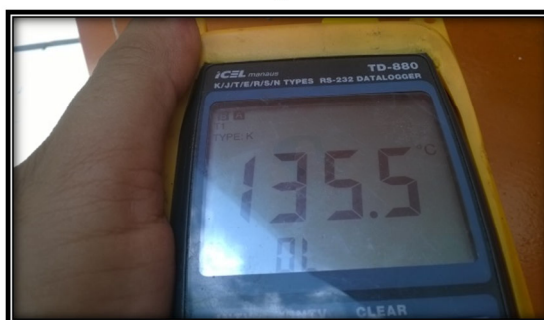
Figura 52 – Temperatura máxima na chapa do absorvedor do forno solar estudado.
