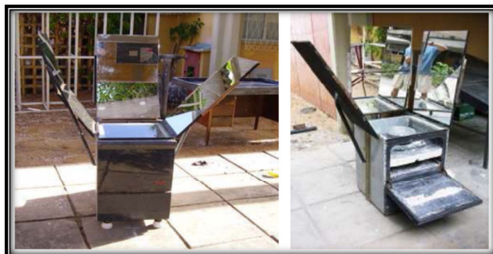
Figura 18 – Forno solar fabricado a partir de uma sucata de fogão convencional a gás.
