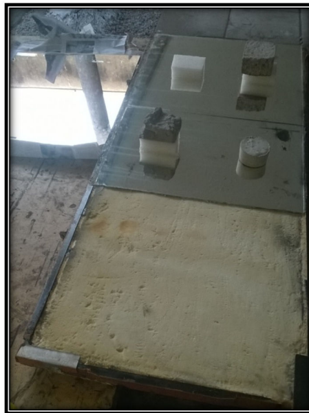
Figura 35 – Colagem dos espelhos na porta da geladeira.
