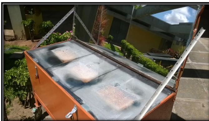
Figura 65 – Condensação durante o ensaio com carne.
