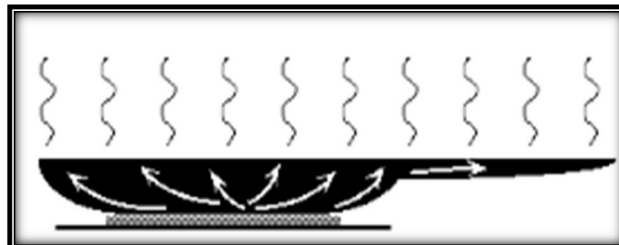
Figura 11 – Calor da panela transferido para o cabo.
