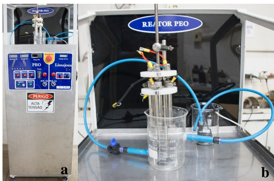
Figura 2 – (a) Equipamento para tratamento por Oxidação por Plasma Eletrolítico (PEO) e (b) Reatores, sistema de controle de vazão e termopar. Autoria própria (2017).
