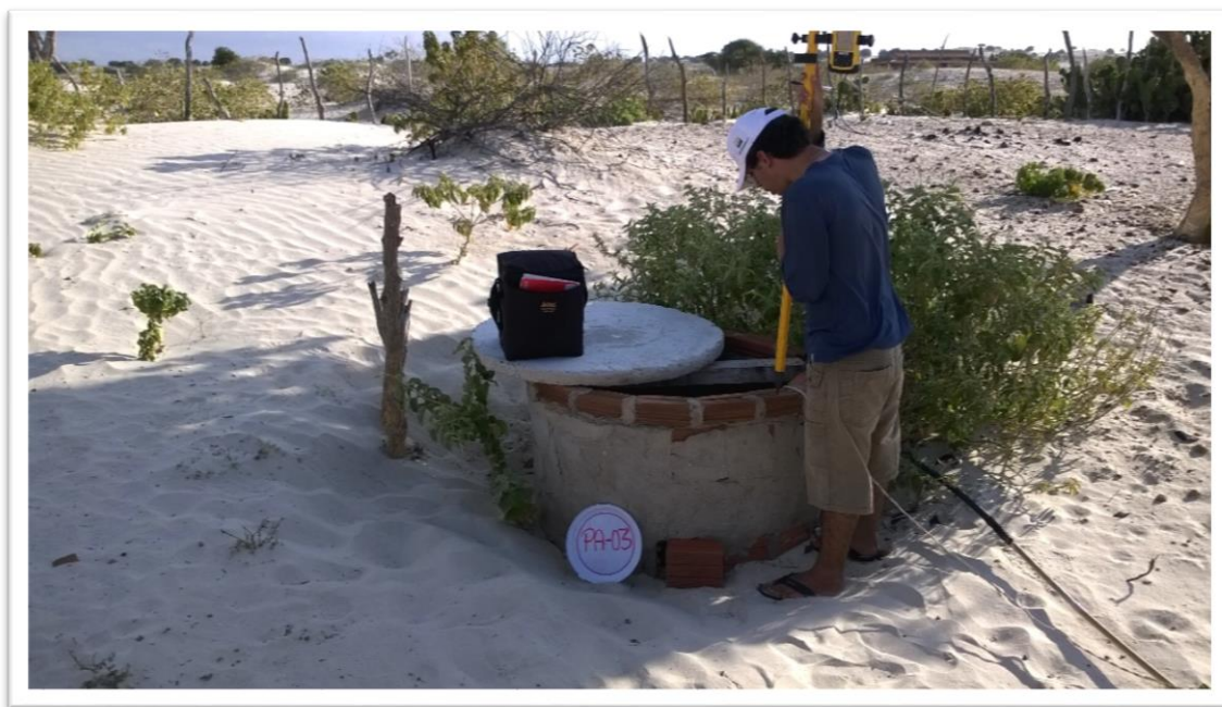
Figura 4.1 Foto de poço tipo cacimbão encontrado na área e procedimentos de nivelamentos topográficos.
