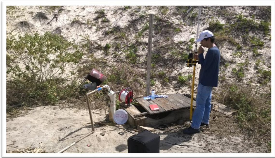
Figura 4.2– Foto de poço tipo tubular encontrado na área e procedimentos de nivelamentos topográficos.
