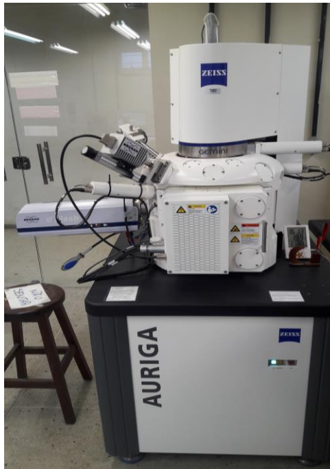
Figura 14 - Microscópio eletrônico de varredura (MEV-FEG, Carl Zeiss Microscopy, Auriga, Alemanha) com detector de elétrons secundários em baixo vácuo. Fonte: a autora.
