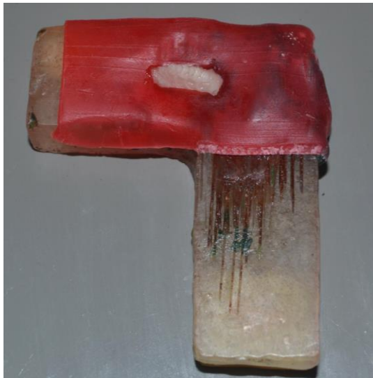
Figura 16 – Fixação das hemiarcadas em dispositivo confeccionado em resina acrílica.
