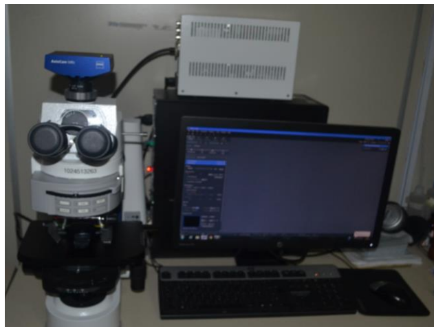
Figura 19 - Microscópio reto de fluorescência e campo claro Zeiss Imager A.2. Fonte: a autora.
