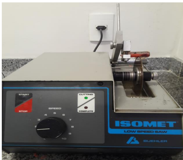
Figura 17 - Corte dos elementos dentários com disco diamantado a 200 rpm (Isomet; Buehler, Lake Bluff, IL, USA).
