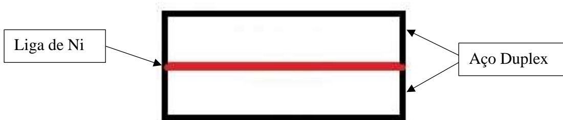
Figura 4.2-3 Desenho esquemático da montagem das amostras de aço inoxidável duplex para brasagem..
