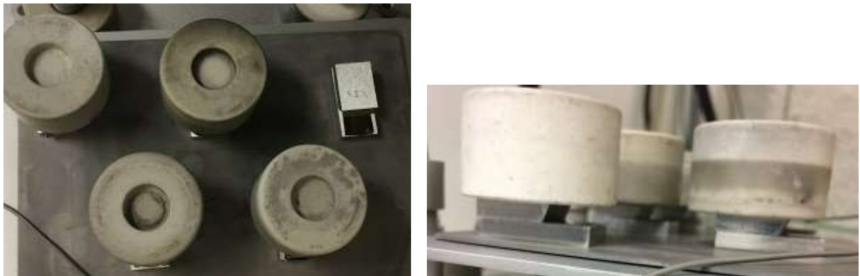
Figura 4.2-5 Montagem do ensaio em cunha com utilização de peso cerâmico.
